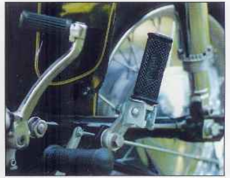
Gyári a hátsó lábtartó gumija, sajnos az első még hiányzik
