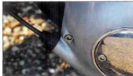
Ez már a módosított kuplungbóvden-bevezetés
