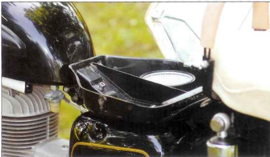
A nyereg alatti doboz hátulján sorakozó furatokon keresztül szívja a levegőt a motor
